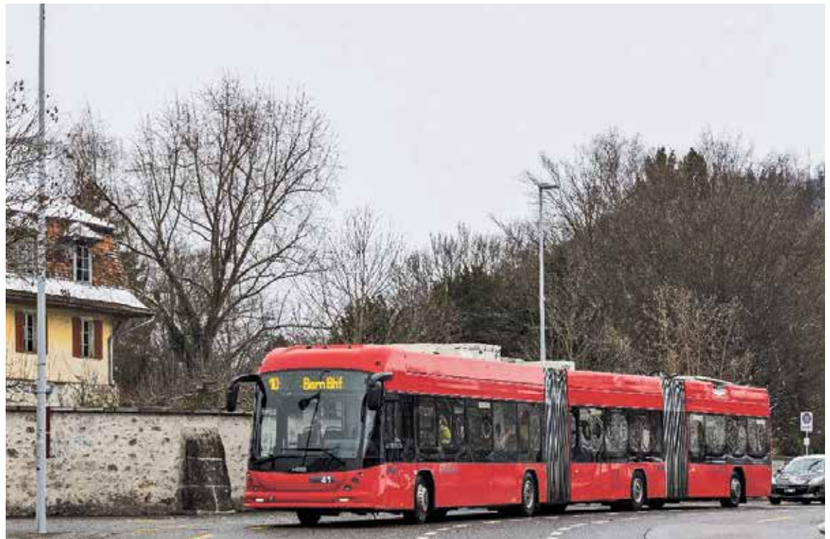
Die neuen Doppelgelenktrrolleybusse auf der Linie 10 brauchen Fahrleitungen, Gleitrichter und neue Haltestellen (Foto: Stadt Bern: Direktion für Tiefbau, Verkehr und Stadtgrün)
